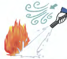
④ เข้าทางเหนือลม และฉีดไปที่ฐานของไฟ พร้อมกับสายสายไปมาซ้ายและขวา
