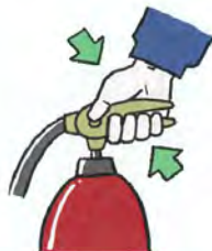
③ กดก้านขึ้นบน หรือบีบก้านเข้าหากัน เพื่อทำการฉีดสารออกมา
